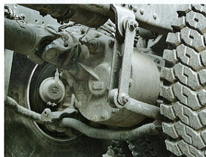
На самосвалы ставят пару стабилизаторов поперечной устойчивости
