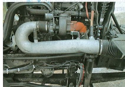
IVECO применяет турбины компании Holset, входящей в состав Cummins
