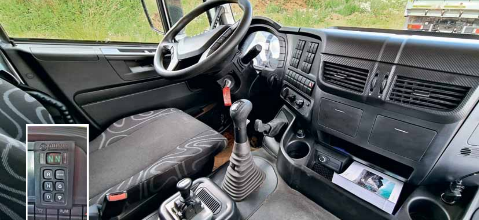
Переключением передач у IVECO Trakker ведаёт 16-ступенчатая МКП ZF Ecosplit, у IVECO-AMT – 6-скоростная ГМП Allison
