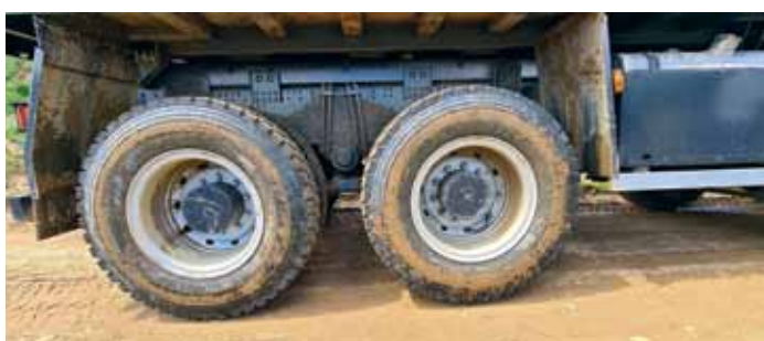
IVECO-AMT: мосты Kessler задней тележки рассчитаны на осевую нагрузку 20 т каждый
