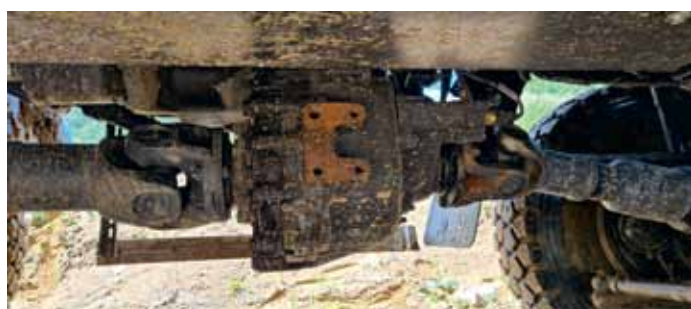
IVECO-AMT: Раздаточная коробка носит клеймо ZF
